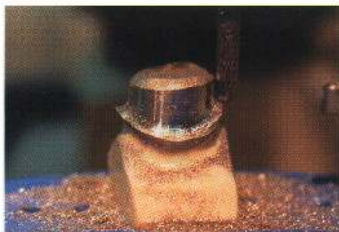
Fig. 28. En la microfresadora se repasa el frizado de las superficies.
